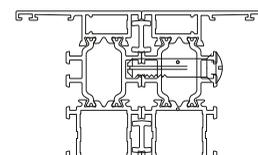
Accouplement de châssis avec profil standard
