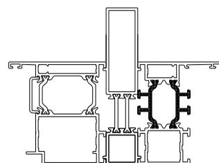
Accouplement de châssis avec profil renforcé
